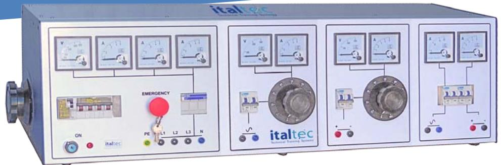
Il modulo di alimentazione è in grado di fornire tutti i livelli di tensione, CA (monofase e trifase) e CC, necessari per le armature e le eccitazioni di tutta la gamma di macchine elettriche e freni del sistema EMMS3. Il dispositivo è protetto con interruttore generale automatico con sezione differenziale ad alta sensibilità (0,03A) e ogni singola uscita è protetta con un interruttore magneto-termico dedicato.
