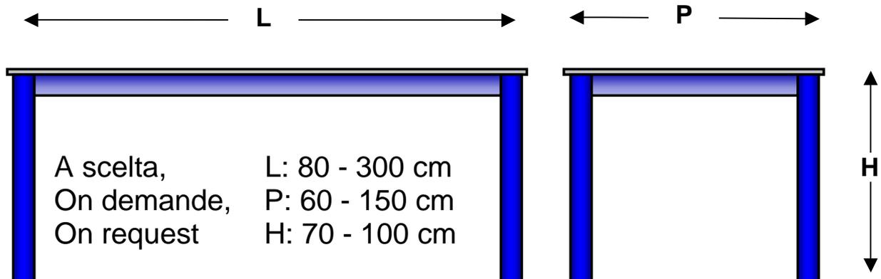
Struttura in profilato d'acciaio mm.80x20, trattata antiruggine e verniciata in epossidico senza solventi, a forno. Gambe cilindriche diam. mm 80 x 20 con piedi regolabili per livellamento su pavimenti irregolari. Piano di lavoro di legno bilaminato bordato in PVC con angoli arrotondati. Carico ammesso senza nessuna deformazione: 1200 kg
