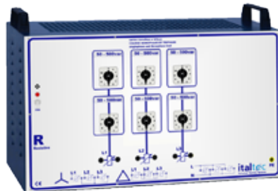
MOD. 6020-R20T Charge résistive pour dynamos et pour alternateur triphasé; Démarrateur pour moteur c.c., Régulateur de vitesse pour moteur à bague • Résistance variable de 3x5-100%; • Puissance nom.: 150W - 3300W • Triphasé et monophasé; (monophasé avec 60 étapes de régulation);
