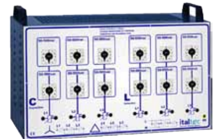
MOD.6020-LC20T Charge pour alternateur triphasé Charge inductives et capacitives; Variable avec 20 pas de régulation de 5% à 100%; Triphasé et monophasé; (monophasé avec 60 étapes de régulation); Dim. 70x40x40cm;
