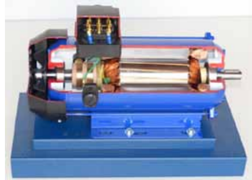
MOD.3070 Machine synchrone triphasée Moteur/alternateur
